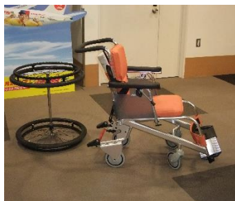
【写真4 車輪が外れる車椅子】
